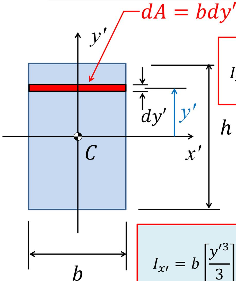
$$I_{x'} = \int_{-\frac{h}{2}}^{\frac{h}{2}} y'^2 b dy' = b \int_{-\frac{h}{2}}^{\frac{h}{2}} y'^2 dy'$$
